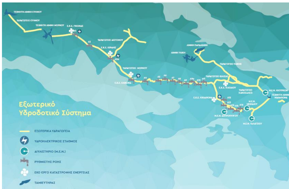
Εικόνα 1.1. Εξωτερικό Υδροδοτικό Σύστημα και Μονάδες Επεξεργασίας Νερού (ΜΕΝ) ΕΥΔΑΠ ΑΕ
